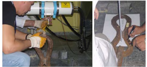
Resim 9a-9b: Tüp odağı ile bakla arasındaki mesafenin ayarlanması ve numaralandırma işlemi.
