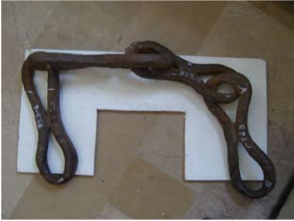
Resim 7: Radyografik incelemeleri yapılan dört baklalı zincir (Rz3).
