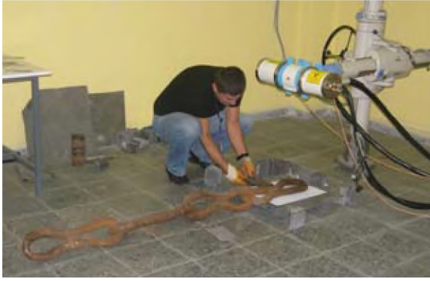
Resim 10: Zincirin radyografiye hazırlanması.
