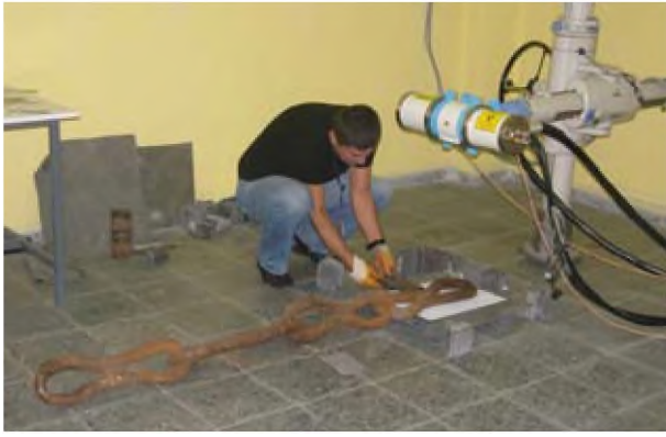
Resim 10: Zincirin radyografiye hazırlanması.
