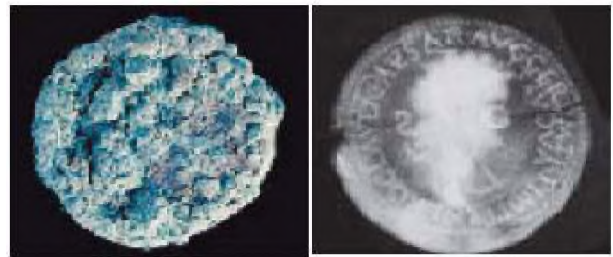
Resim 3a-3b: Korozyon ürünleri ile kaplı durumda olan bronz sikkenin X-ışını ile yapılan muayenesinde elde edilen radyograf görüntüsünde gözle görülemeyen bir portrenin varlığı ve onu çevreleyen yazı kuşağı okunabilmektedir.
