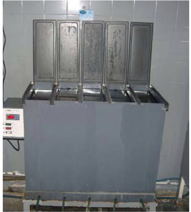
Resim 13: Çekimi tamamlanan filmler, karanlık adada sırasıyla; geliştirme, durdurma ve tespit işlemleri yapılarak banyo edilmiştir.
