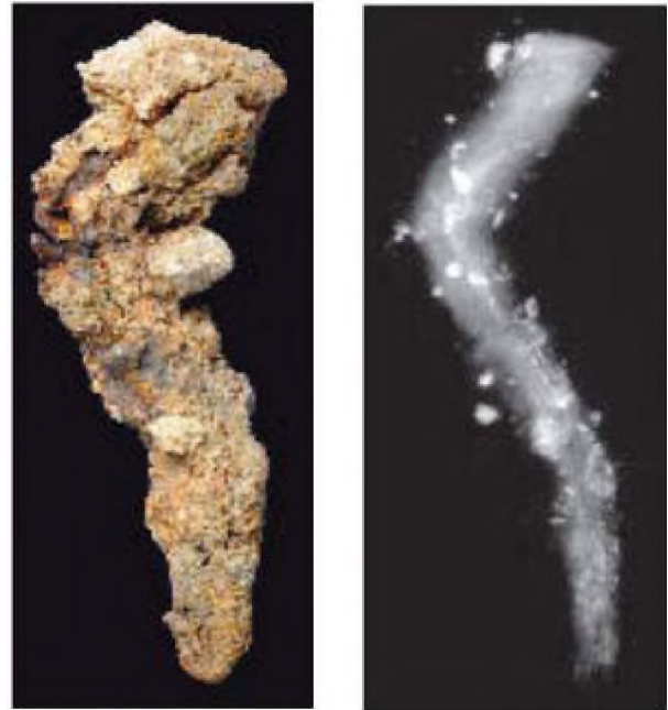
Resim 6a-6b: Yüzeyi tamamen kaplanmış demir çapanın formu radyografi ile görüntülenmektedir.
