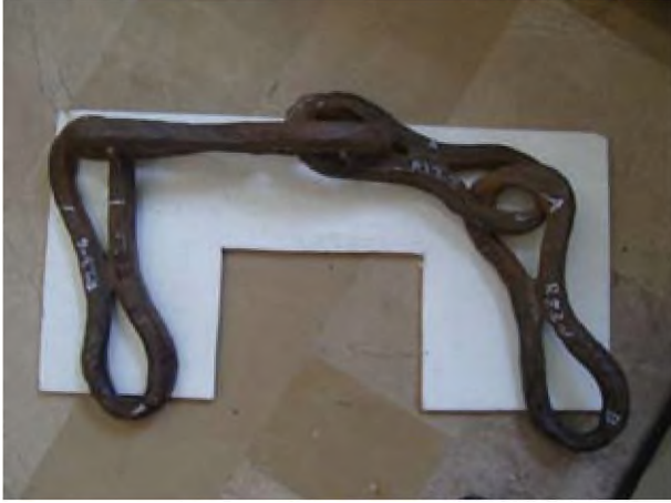
Resim 7: Radyografik incelemeleri yapılan dört baklalı zincir (Rz3).
