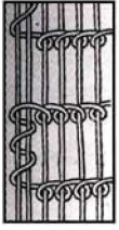
Şekil 1: Sumak tekniğiyle iki çözgü iplik grubuna bağlanarak kenar ipliklerinin dönüşünü gösteren balık ağı dokulu kumaşın yapısı (Burnham 1965).
