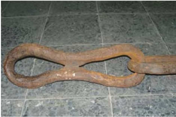
Resim 12: PTXRF analizi yapılan zincir baklası.
