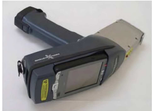
Resim 5: Taşınabilir Portatif XRF Cihazı
