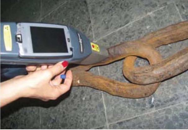
Resim 13: PTXRF cihazı ve kullanımı.
