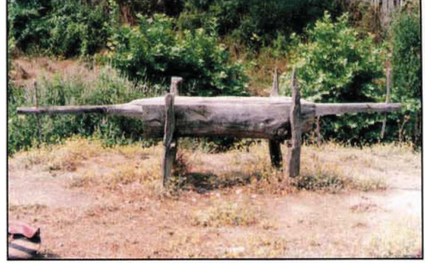
Resim 7: Keçeleştirme işleminin yapıldığı düzenek, "dink"
